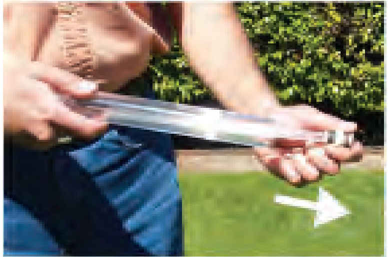
Figura 25. Retirando el Tubo de Aire Superior de la Escala de Cabeza de Pozo.
